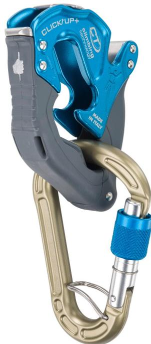
CLICK UP+ es un innovador asegurador de frenado manual, evolución del bien establecido modelo [CLICK UP](#), en el mercado desde nada menos que siete años. Diseñado específicamente para la escalada en rocódromo y en paredes de deportiva, puede utilizarse con todo tipo de cuerdas simples dinámicas de  $\varnothing 8.5\div 11$  mm. Compacto y ligero, permite asegurar a un primero o asegurar en top-rope, controlando la cuerda con ambas manos.
